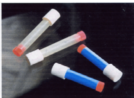
Figura 7. Tubos de difusión pasiva utilizados para la determinación de ozono y dióxido de nitrógeno.
