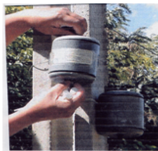
Figura 2. Contenedor para tubos pasivos de ozono y dióxido de nitrógeno utilizados en monitoreo de la calidad de aire.
